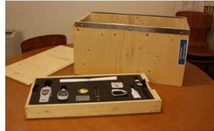
In der LärmKiste sind Informationsmaterialien für die Lehrperson. Anschauungs- und Versuchsmaterial, Ohr-Modell, Schallpegelmessgerät, Geräusch-CD's, Videos, Gehörschutz usw. bieten eine Auswahl für die Experimente und ergänzen die Arbeit mit der Mappe "Ohrwürmer".
